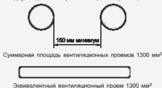
Рисунок 7— Пример разных конструкций вентиляционных отверстий
